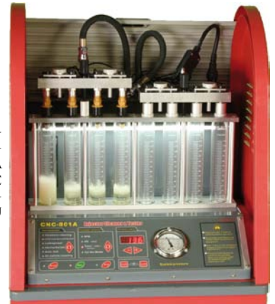
PODŚWIETLANIE MENZUREK ZWIĘKSZA DOKŁADNOŚĆ OCENY PARAMETRÓW WTRYSKU
