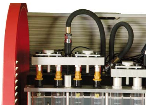
LISTWA ZASILAJĄCA PALIEM TESTOWANE WTRYSKIWACZE
