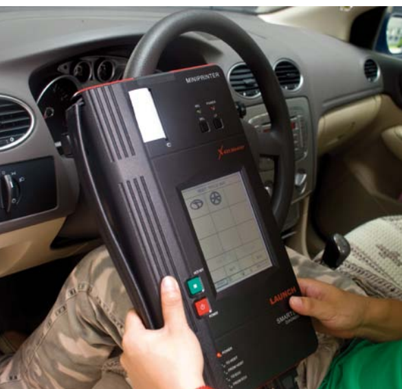
PRZYRZĄD DIAGNOSTYCZNE DO OBSŁUGI ELEKTRONICZNYCH SYSTEMÓW STERUJĄCYCH X-431 MASTER
