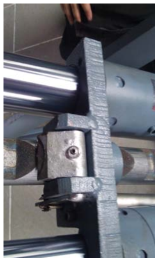
ZAPADKI NA LISTWIE ZĘBATEJ ODBLOKOWYWANE PNEUMATYCZNIE
