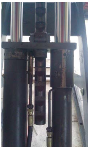
MECHANICZNE, ZĘBĄTKOWO-ZAPADKOWE ZABEZPIECZENIE POMOSTU PODNOŚNIKA NOŻYCOWEGO
