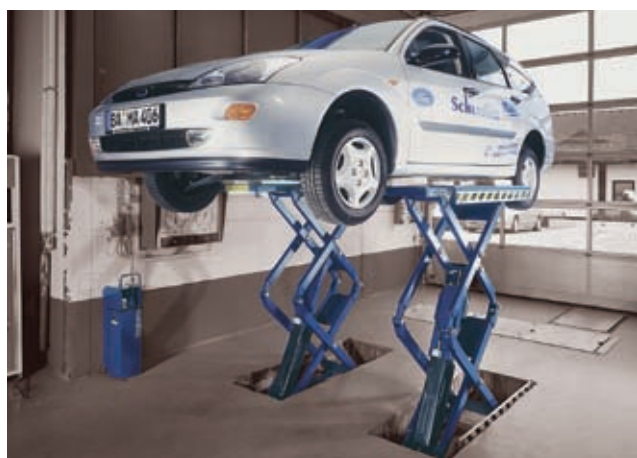
Podprogowy podnośnik nożycowy wpuszczany w posadzkę – po złożeniu podłoga jest płaska. Koła jezdne nie dotykają płyt
