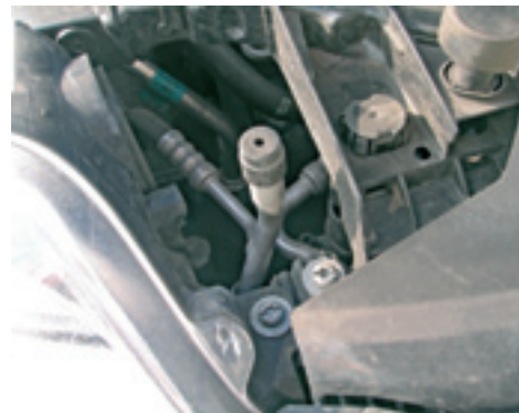
Złącze serwisowe obwodu wysokiego ciśnienia układu klimatyzacji.
