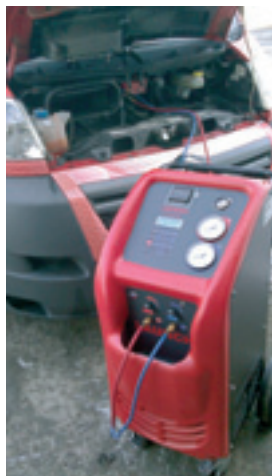
Przy obsłudze systemów klimatyzacji niezbędne jest wykorzystanie stacji serwisowej.
