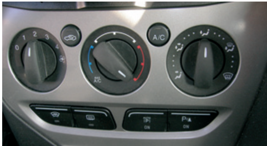
Panel sterowania układu klimatyzacji manualnej.
