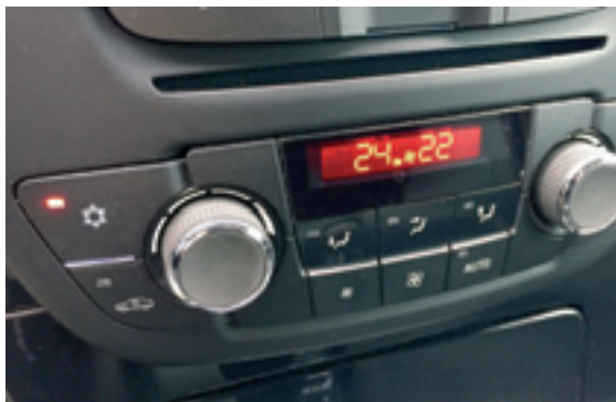
Automatyczny panel sterowania układu klimatyzacji.
