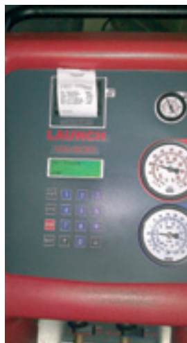
Standardem automatycznych stacji serwisowych jest wbudowana drukarka i baza danych.
