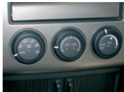
Panel sterowania klimatyzacji manualnej.
