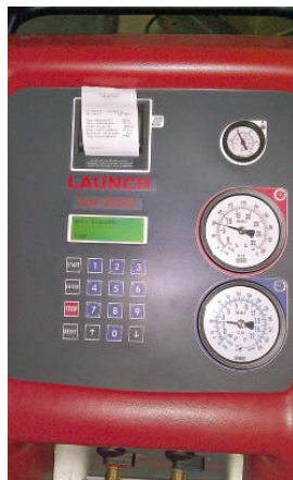
Sezonowa obsługa układu klimatyzacji z użyciem w pełni automatycznej stacji serwisowej.
