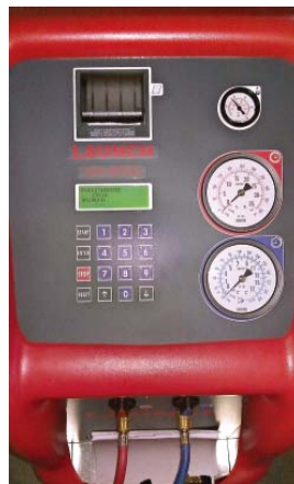
Urządzenia w pełni automatyczne posiadają bazę danych parametrów obsługiwanych pojazdów z wartościami ilości czynnika.
