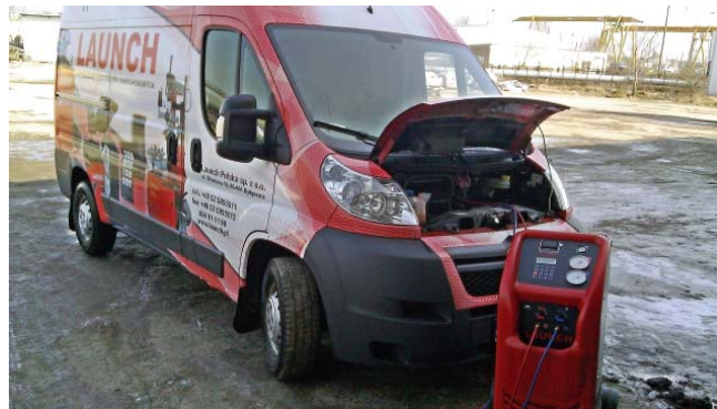
Stacja serwisowa jest niezbędnym urządzeniem przy prowadzeniu usług związanych z obsługą układów klimatyzacji.
