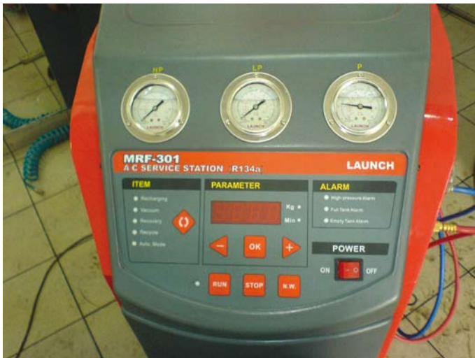
Profesjonalna obsługa układów klimatyzacji wymaga zastosowania stacji serwisowej
