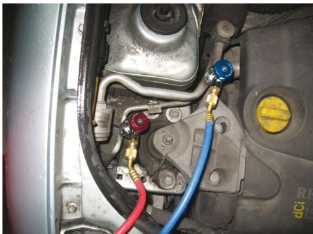
Obsługa klimatyzacji samochodowej wymaga podłączenia stacji serwisowej do układu niskiego i wysokiego ciśnienia
