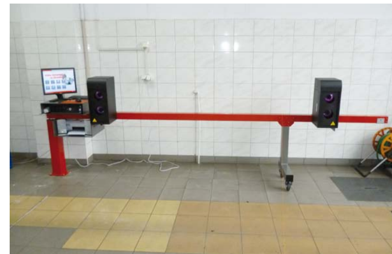
WERSJA KANAŁOWA URZĄDZENIA 3D NA SZLĄBNIENIE UMOŻLIWIAJĄCA ODCHYLENIE W PRZYPADKU KONIECZNOŚCI UZYSKANIA STANOWISKA PRZELOTOWEGO
