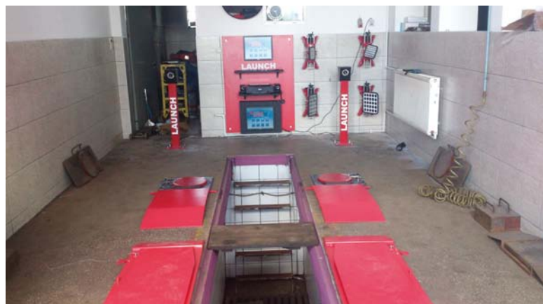
WERSJA KANAŁOWA URZĄDZENIA 3D Z SŁUPKAMI PO BOKACH STANOWISKA
