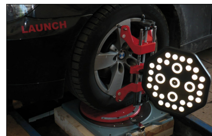
Zmodyfikowane urządzenie KWA-300 3D, z kamerami umieszczonymi na uchylnym ramieniu, umożliwiającym obsługę szerszych pojazdów
