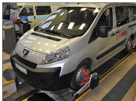
Urządzenie X-631 w trakcie pomiaru
