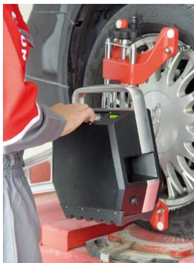
SPOSÓB MOCOWANIA GŁOWICY DO OBRĘCZY KOŁA
