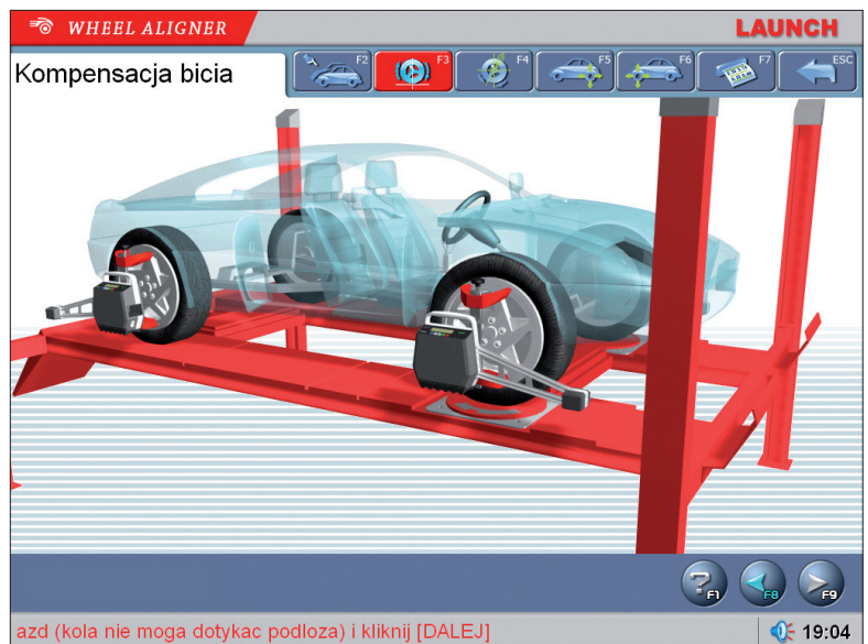
LASEROWY POMIAR ZBIEŻNOŚCI KÓŁ PRZEDNICH Z ZASTOSOWANIEM PRECYZYJNEJ OBROTNICZY (ZDĘCIE ŚRODKOWE) I UNIWERSALNEGO UCHWYTU GŁOWICY (Z PRAWY) UMOŻLIWIĄJĄCEGO KOMPENSOWANIE BICIA OBRĘCZY
