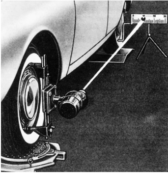
LASEROWY POMIAR ZBIEŻNOŚCI KÓŁ PRZEDNICH Z ZASTOSOWANIEM PRECYZYJNEJ OBROTNICZY (ZDĘCIE ŚRODKOWE) I UNIWERSALNEGO UCHWYTU GŁOWICY (Z PRAWY) UMOŻLIWIĄJĄCEGO KOMPENSOWANIE BICIA OBRĘCZY
